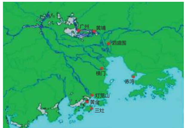
图 3.9 珠江三角洲在现有防潮设施情况下, 海平面上升 30 厘米, 并遇到历史最高潮位, 海水可能淹没范围
